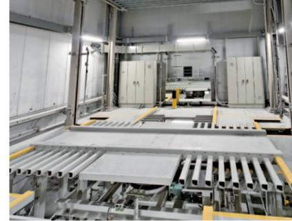
90度旋回したトレーから、フォークリフトで車を取寄棚へ搬送
