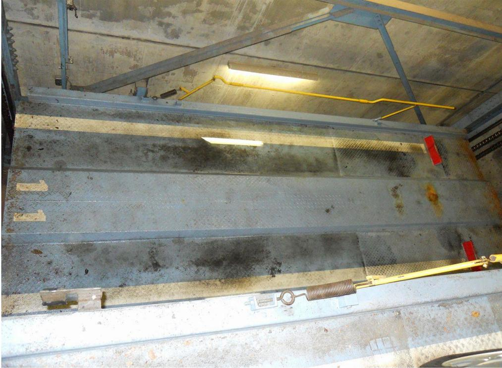
1.リプレース工事前(腐食の進んだ塗装トレー)
