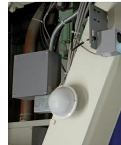
車長・車幅検知はもちろんの事、人感センサーも標準装置。
