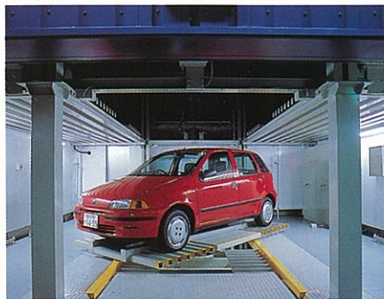
フォーク式方向転換装置（ターンテーブル）内蔵により前進入庫・前進出庫が可能で、初心者ドライバーでも安心して利用できます。
