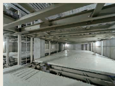
トレー車輪支持方式によって縦横無尽に水平循環
