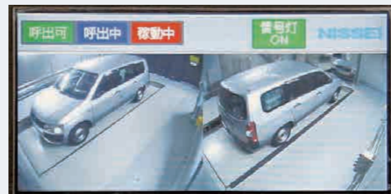
モニター表示 乗降室内にカメラを標準装備。操作盤の液晶で入出庫を確認できます。
